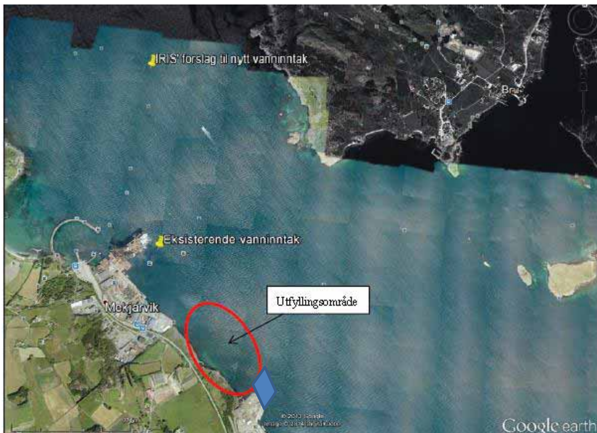
Figur 5 Oversikt over plassering IRIS vanninntak i dag og potensiell ny plassering, (COWI). Denne del av utfyllingen er vist i blått.
