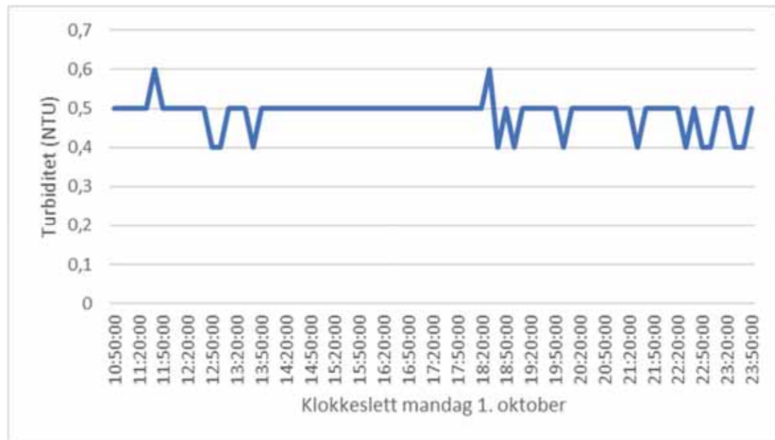
Figur 18: Resultater fra overvåking ved IRIS sitt vanninntak ved stasjon T3, 83 m dyp.
