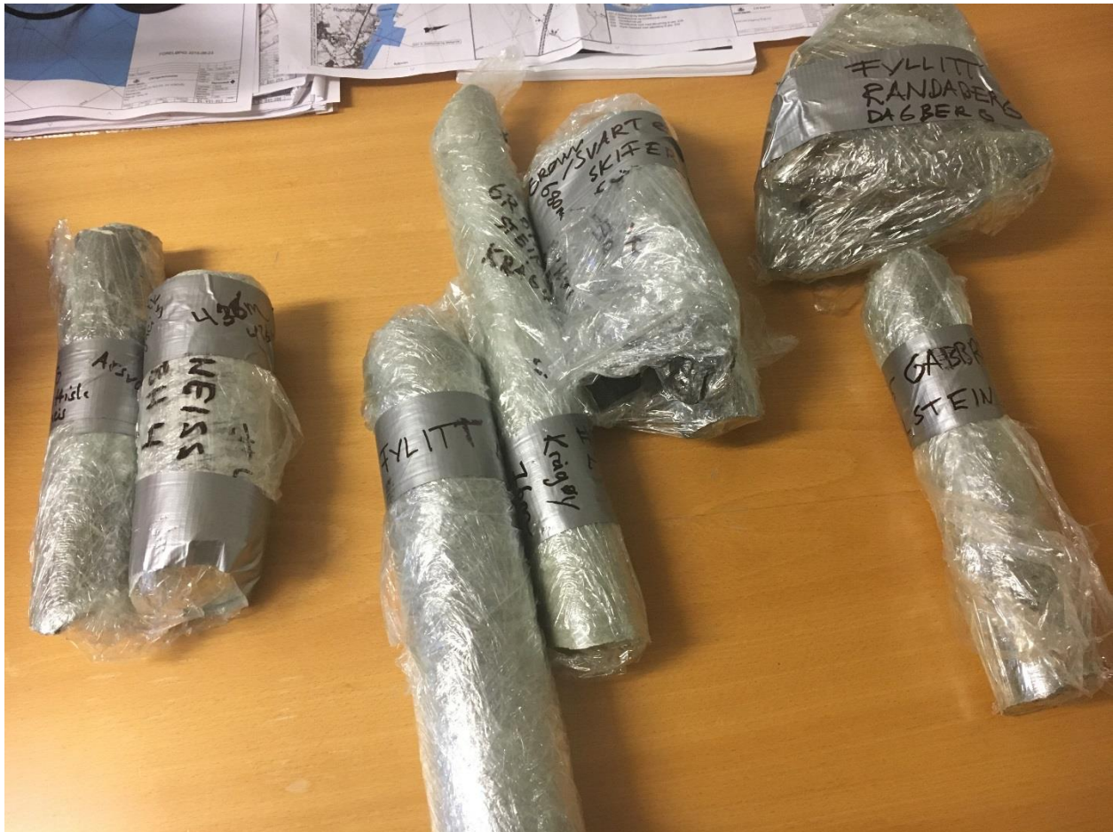
Figur 1 Kjerneprøver av bergarter fra Rogfast-traséen. Oversiktsdata fra venstre til høyre er gitt i tabell 1.
