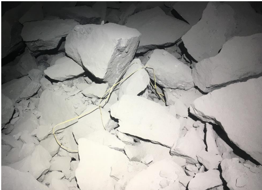
Figur 5: Skyteledning i røysa, testsalve 2
