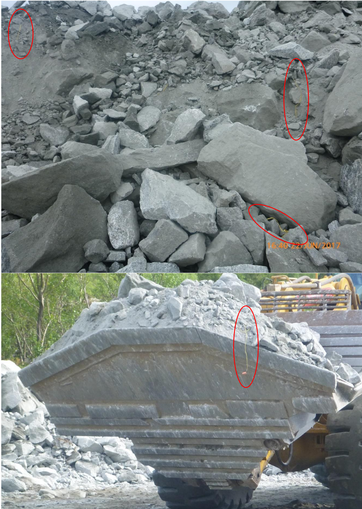
Figur 7: Rester av skyteledding i tunnelmasser
