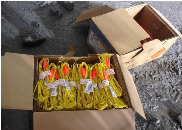
Figur 2: Elektroniske tennere – rød koblingsboks, gul skyteledning (metalltråd kledd med plast) og hvit «tag» med Id-nr på hver enkelt tenner.
