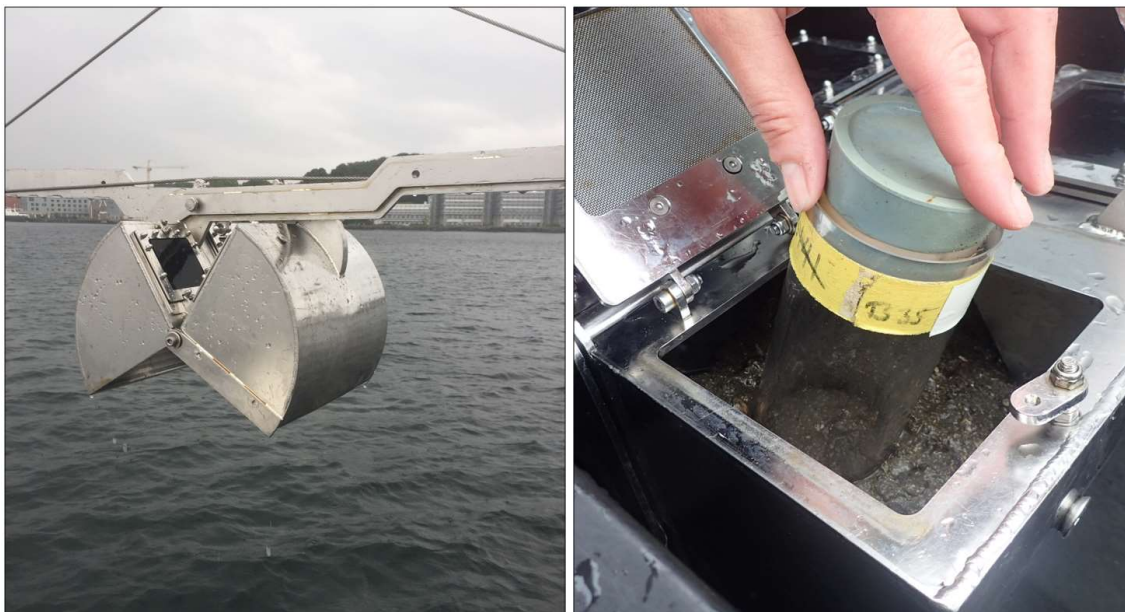
Figur 3: Prøvetaking med grabb (t.v) og uttak av prøve med sylinder (t.h.)
