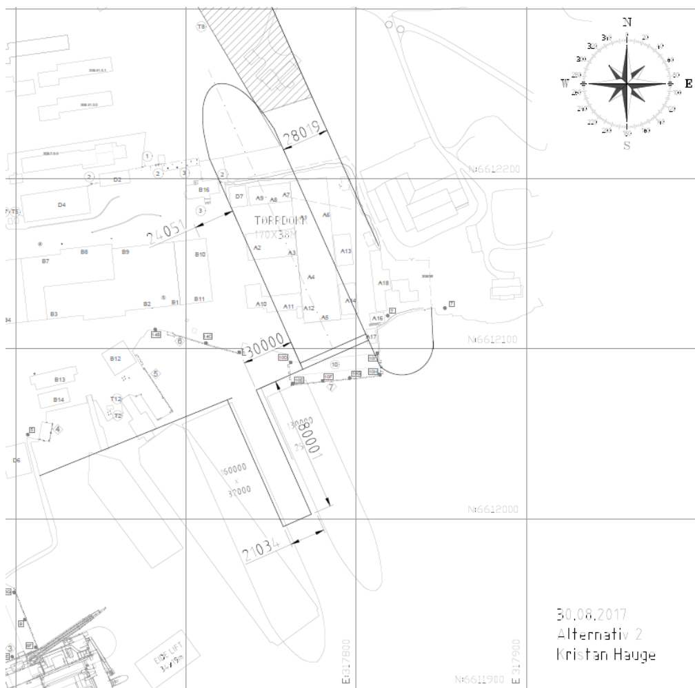
Figur 28: Utsnitt av tegning som viser planlagt plassering av tørrdokk.
