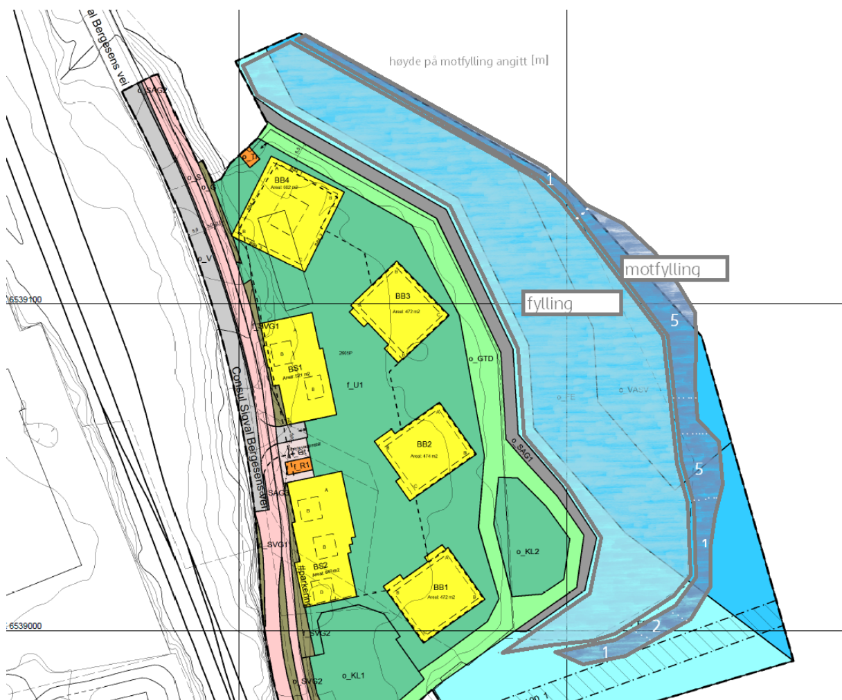
Figur 4 Fylling og motfylling er skissert på plantegning. Detaljer vises på snitt under
