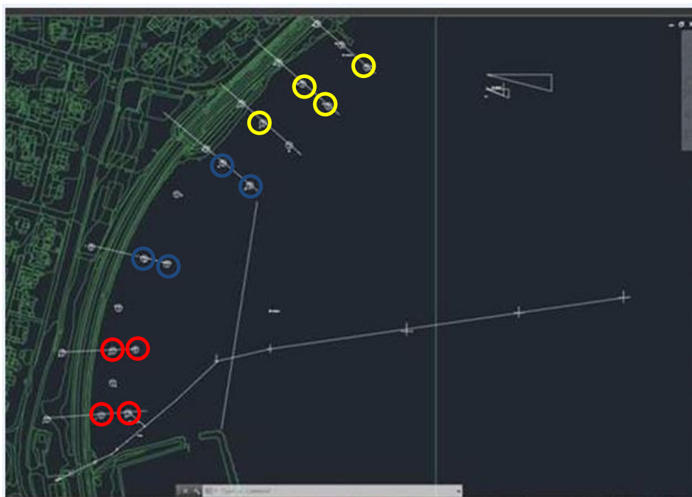
Figur 2. Prøvepunkter i det planlagte tiltaksområdet som ble prøvetatt med grabb. Fargekodingen indikerer hvilke prøver som ble blandet med hverandre. Røde sirkler indikerer prøver som inngår i blandprøven LV 1, mens blå sirkler indikerer prøver som inngår i blandprøven LV 2, og gule sirkler indikerer prøver som inngår i blandprøven LV 3.
