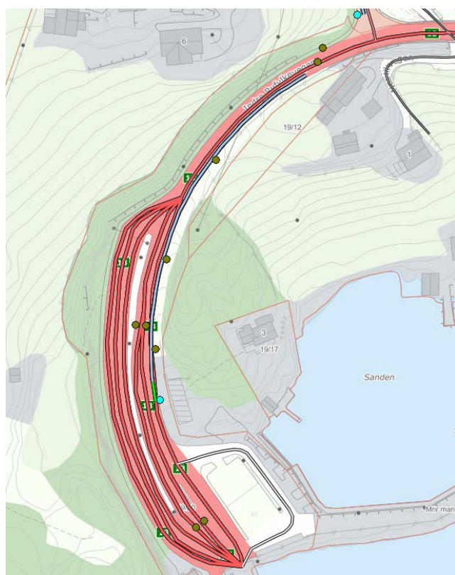
Figur 12 Kart viser kummer og stikkrenner med ringe. Den lyseblå linjen er rørgrøften.
