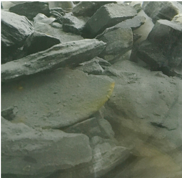
Figur 27. Foto av ROG-01 grønnskifer som i midten av bildet viser rust (jern hydroksid) dannelse fra sulfidmineral oksidering.
