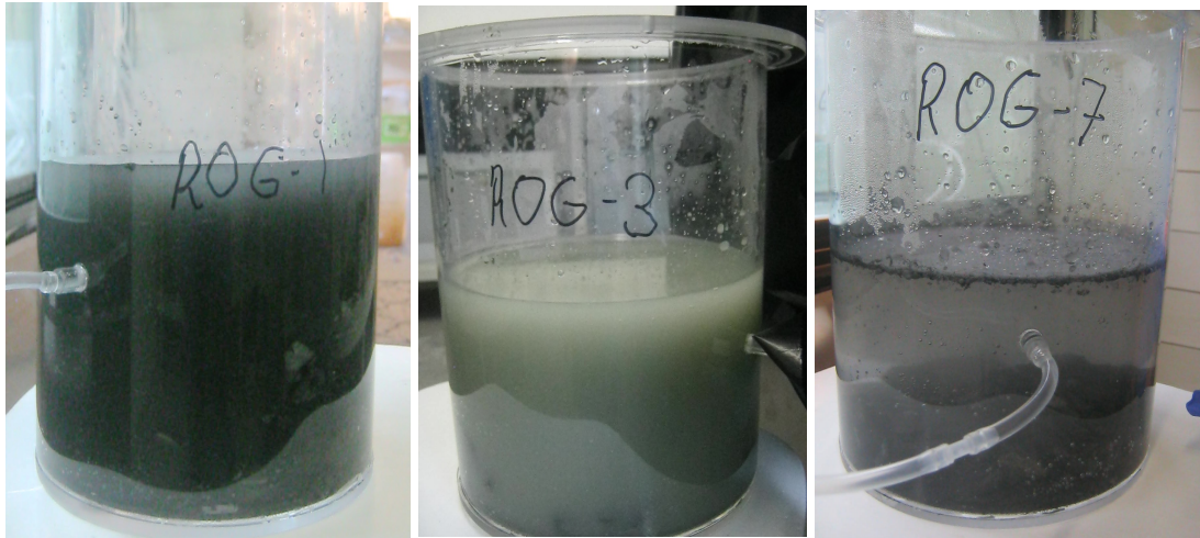
Figur 24. Fotografier av saltvannskolonnene med grønskifer (ROG-1), Grønnstein (ROG 3) og svartskifer (ROG-7), 1-2 timer etter fylling.
