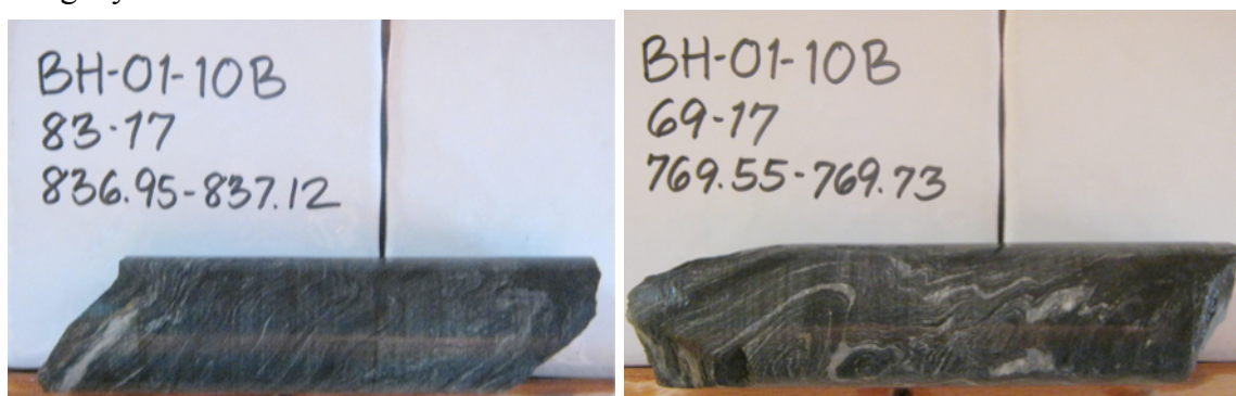
Figur 7. Grønnskifer med tynne kvarstårer, ca 15 cm lang prøve.
