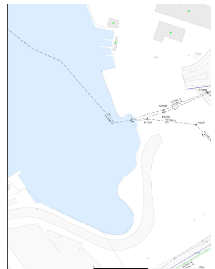
Figur 3: Kommunal overvannsledning 200mm PE100 innenfor tiltaksområdet.
