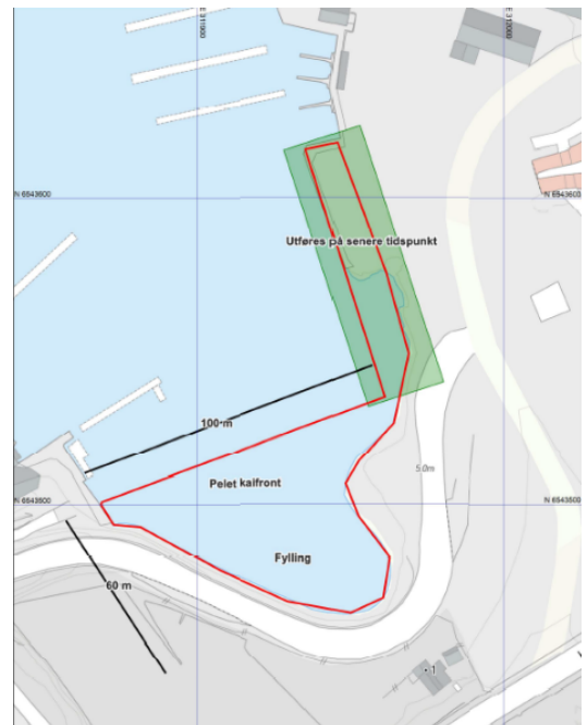
Figur 2: Tiltaksområdet. Rød linje består av utfylling og pelet kaifront. Grønn sone vil utføres på et senere tidspunkt.
