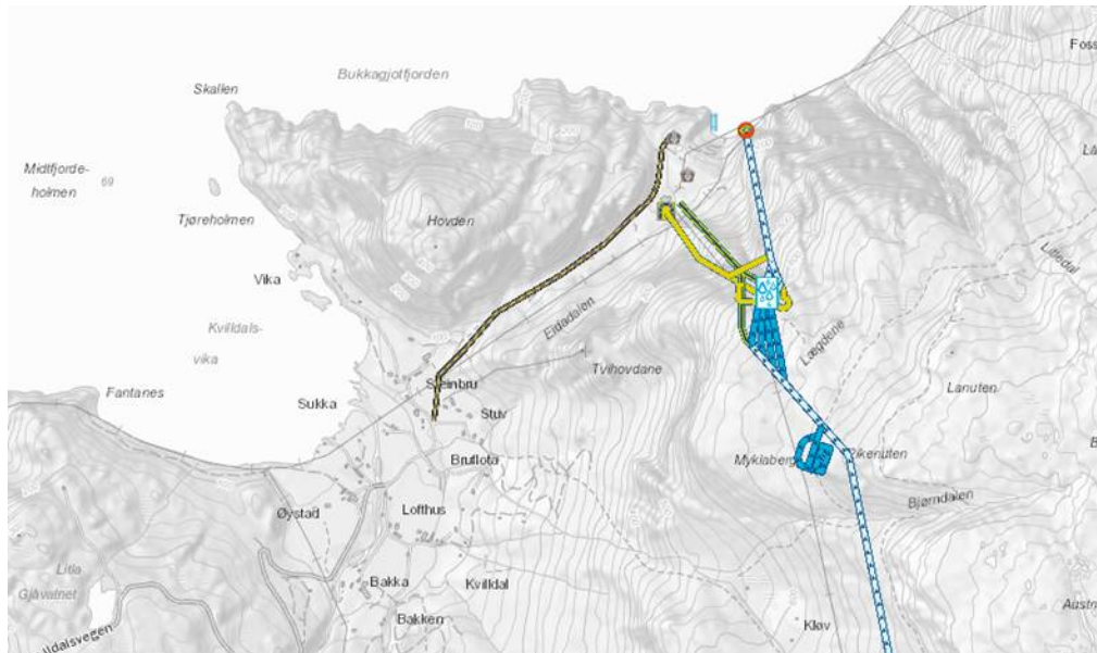
Figur 1: Utslipp av anleggsvann vil bli blandet i avløp fra Kvilldal kraftverk før utslipp til Suldalsvatn.
