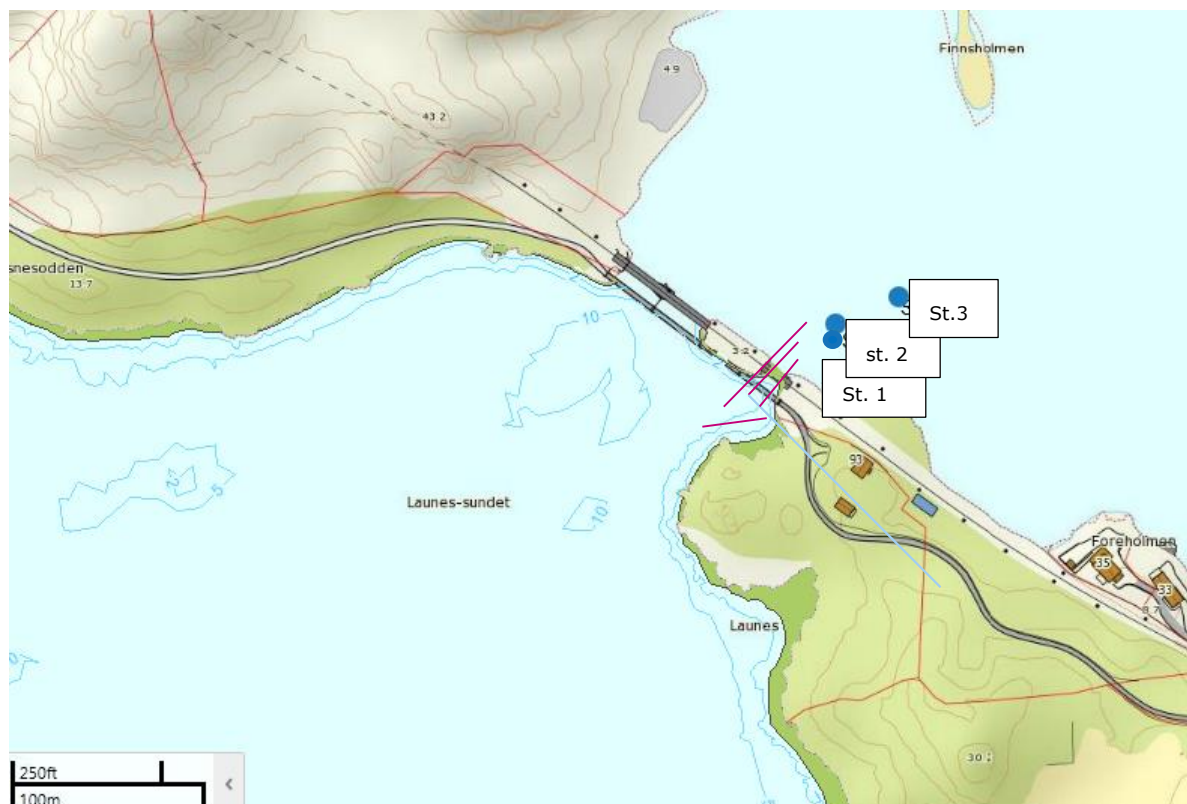
Figur 1: Plassering av stasjoner for prøvetaking av miljøgifter i sediment og plassering av transekter for kartlegging av bunnsubstrat med undervannskamera. Stasjonene for prøvetaking av miljøgifter er merket med blå sirkler, transektene for kartlegging av bunnsubstrat er merket med rosa streker.
