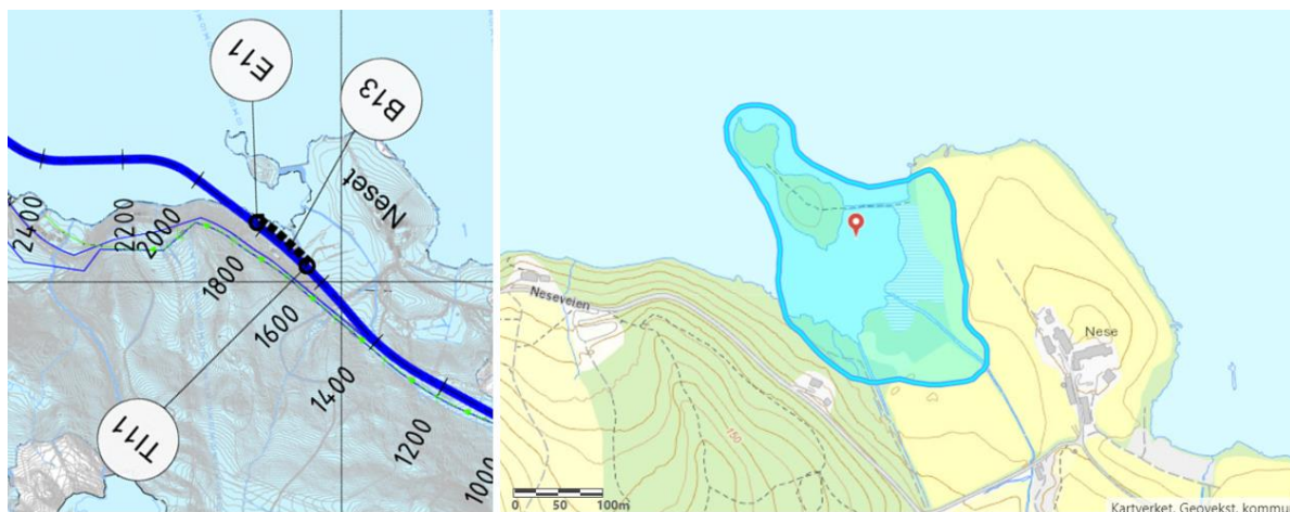
Figur 4: Venstre: Utsnitt fra oversiktstegning (Tegn. nr. 035-HB-U000-012, 31.08.2020) som viser plassering av tappekum T111 med tømning til Edlandsvatnet på østsiden av planlagt ledningstrasé. Høyre: Sumpområdet Nese, BN00037871, fra Miljødirektoratets Naturbase (6).
