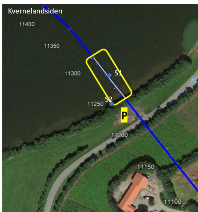
Figur 13: Plassering på sedimentprøver i Frøylandsvatnet, der ledningen skal legges i grøft i sjø, mai 2020.
