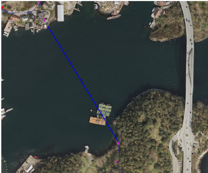
Figur 1. Planlagt trasse for ny vannledning.
