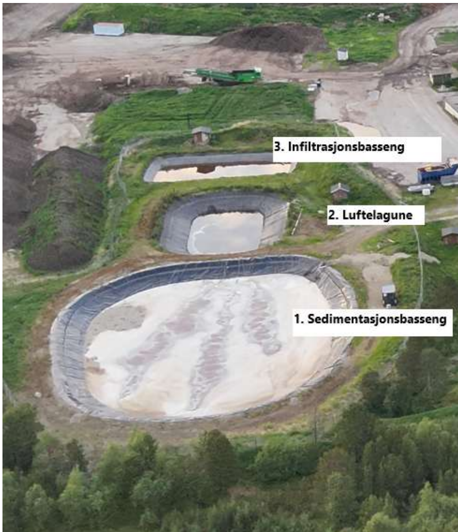
Figur 6: Skisse som viser hvordan renseløsningen vil være utformet i dispensasjonstiden.
