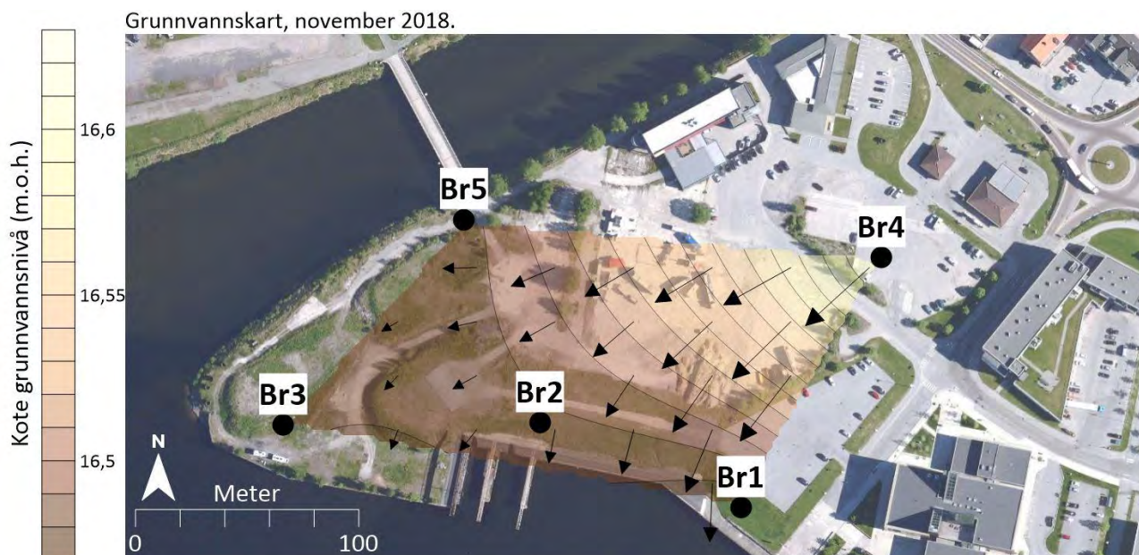
Figur 3: Grunnvannskotekart med piler som indikerer strømningsretning. Kotekartet er basert på grunnvannstandspeilinger fra november 2018.
