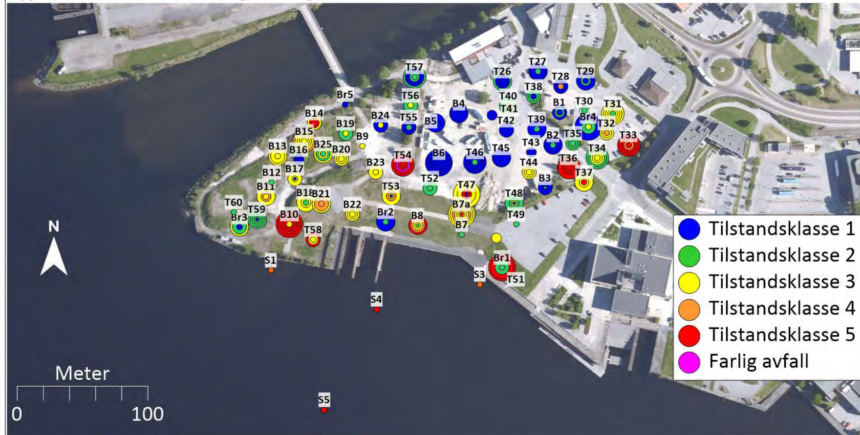
Figur 16 Viser høyeste tilstandsklasse for PAH i jord- og sedimentprøver. Jordprøver: fra 0-1 meter (små sirkler) til 5-6 meter (største sirkler) under terreng/betongdekke.
