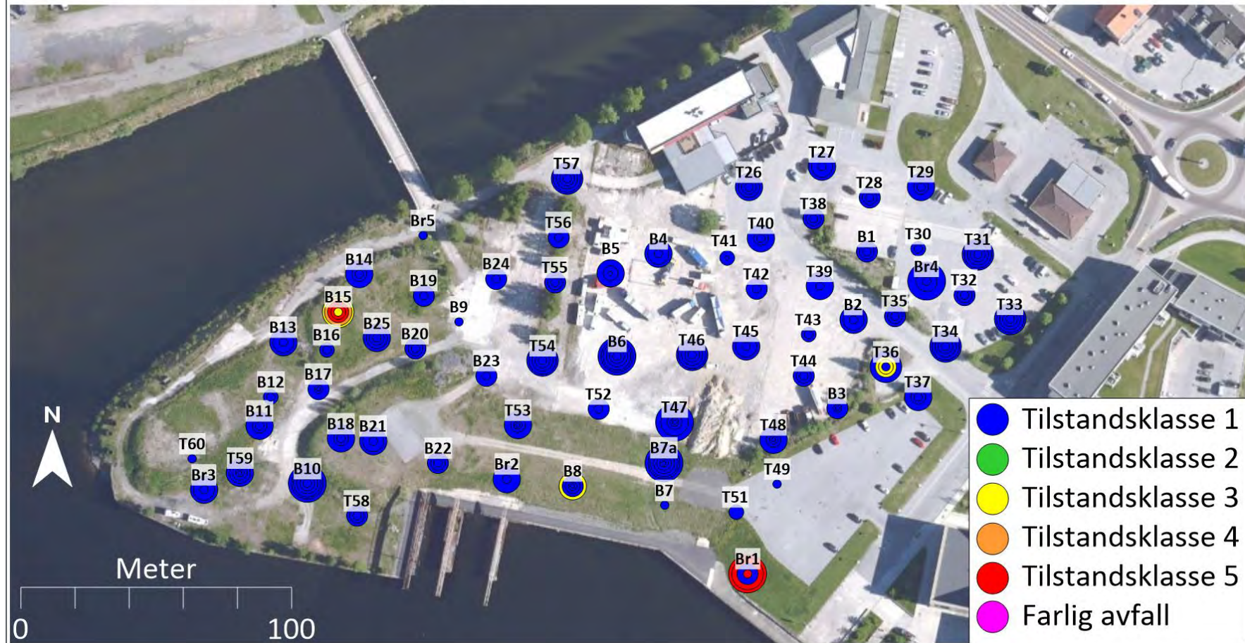
Figur 10 Viser høyeste tilstandsklasse for BTEX. Fra 0-1 meter (små sirkler) til 5-6 meter (største sirkler) under terreng/betongdekke.
