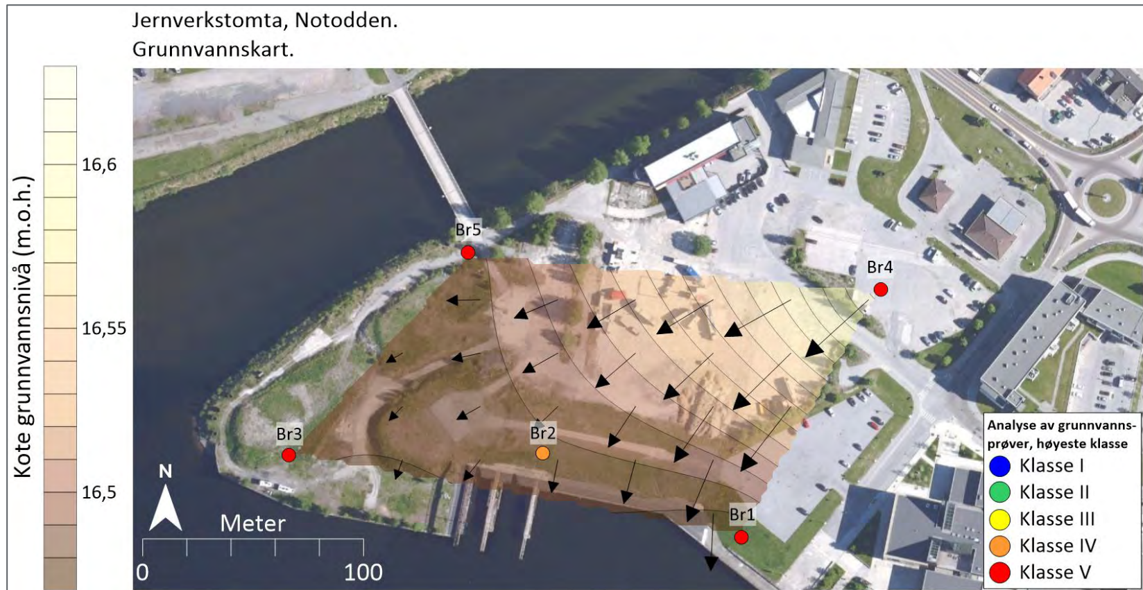
Figur 13 Grunnvannskart for Jernverkstomta for prøvetaking i november 2018. Brønnpunkter viser høyeste målte tilstandsklasse, uavhengig av stoff, fra grunnvannsanalysene i punktet i henhold til veileder 02:2018. Grenseverdiene er beregnet på resipient. Brunfarget område viser grunnvannskoter, i høyde over havet. Piler angir retning på grunnvannsstrøm.
