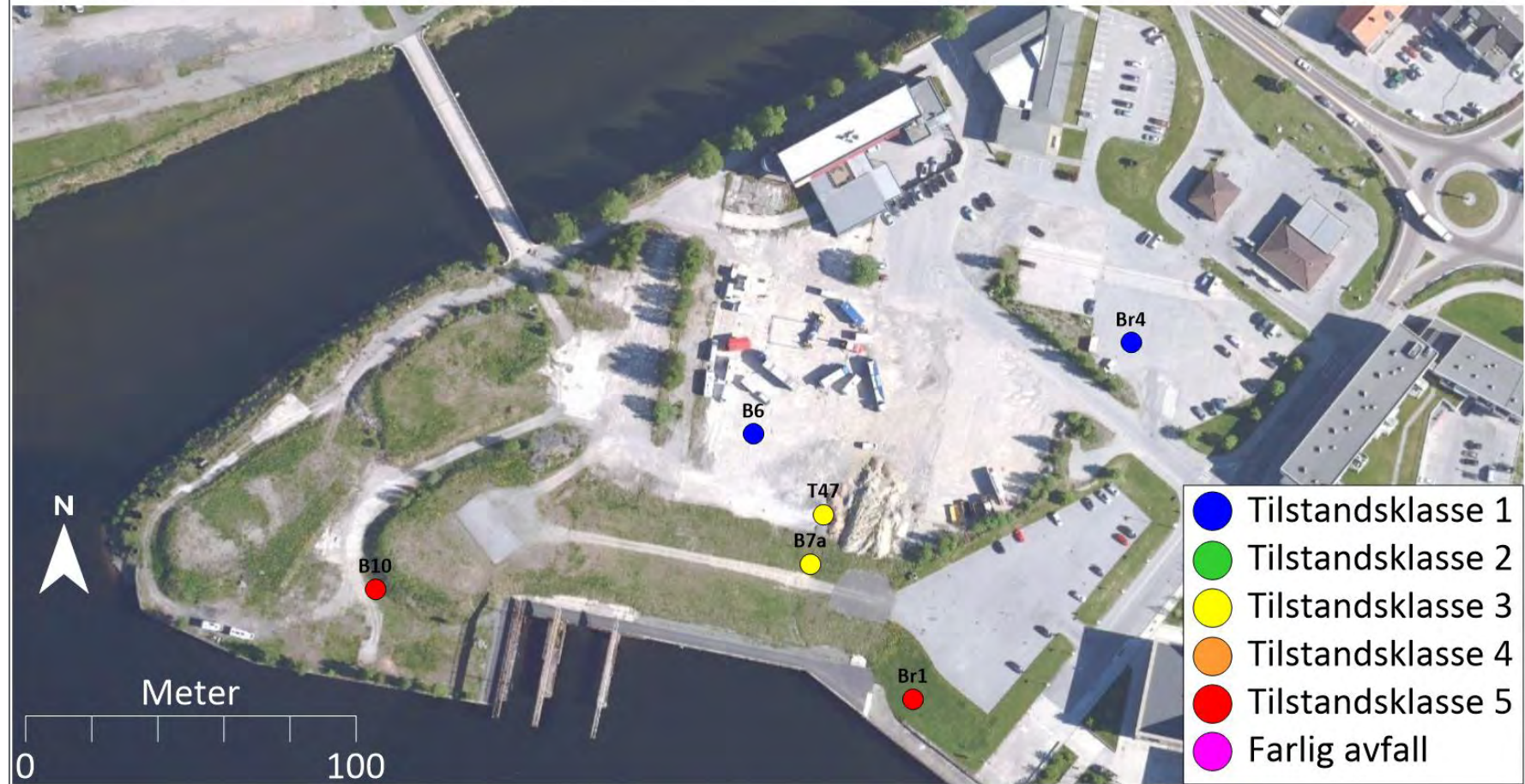
Figur 9 Resultater av prøver av masser i dybden 5 - 6 m under terreng/betongdekke. Tidligere utførte undersøkelser av Noteby/Multiconsult er vist som kvadrater i kartet. Det gjøres oppmerksom på at prøvene fra Noteby/Multiconsult ikke er analysert for alle stoffer.
