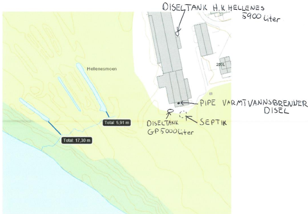
Figur 12. Plassering av septiktank samt lagringstanker for diesel.
