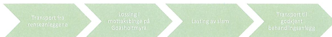
Figur 2: flytdiagram for omlastingsprosessen fra rensesanlegg til uttransport.
