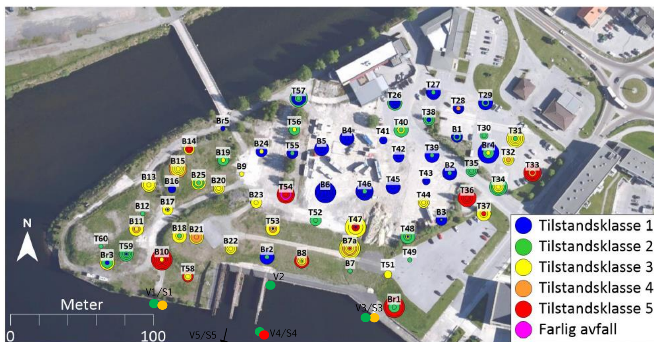
Figur 3: Utsnitt fra figur 11 i Norconsults datarapport [2], som viser høyeste påviste tilstand for PAH i jordmassene, fra 0-6 m dyp. Punkter for vann- (v) og sedimentprøver (s) er omtrentlig markert på kartet. Punkt V5/S5 (tilstandsklasse 5 ligger ca. 150 m syd for de utstikkende kranbanene.
