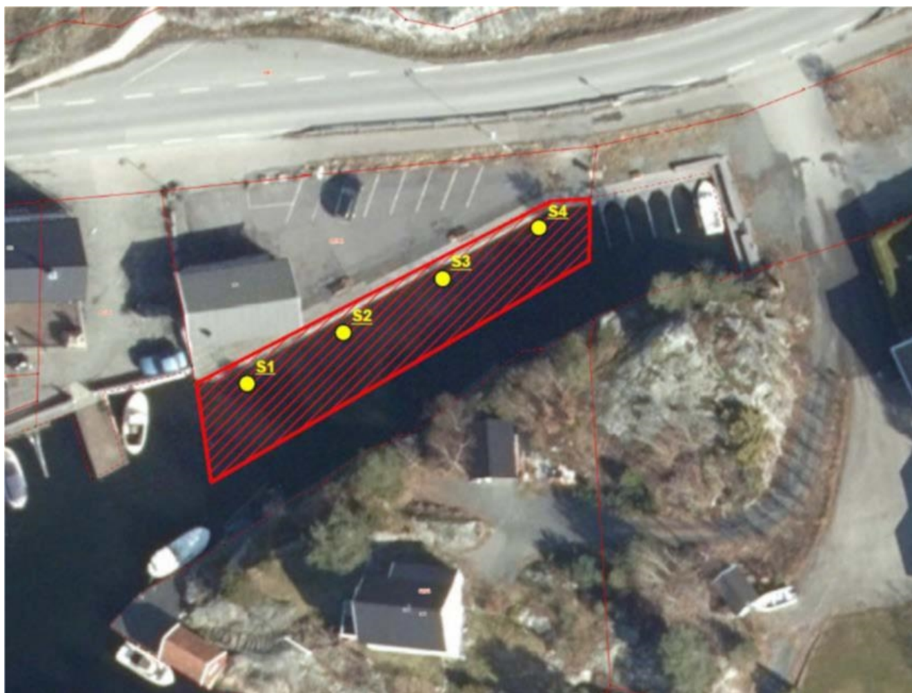
Figur 2. Rødt skravert areal viser området som planlegges mudret, og plassering av de 4 delprøvene er markert med gule sirkler.
