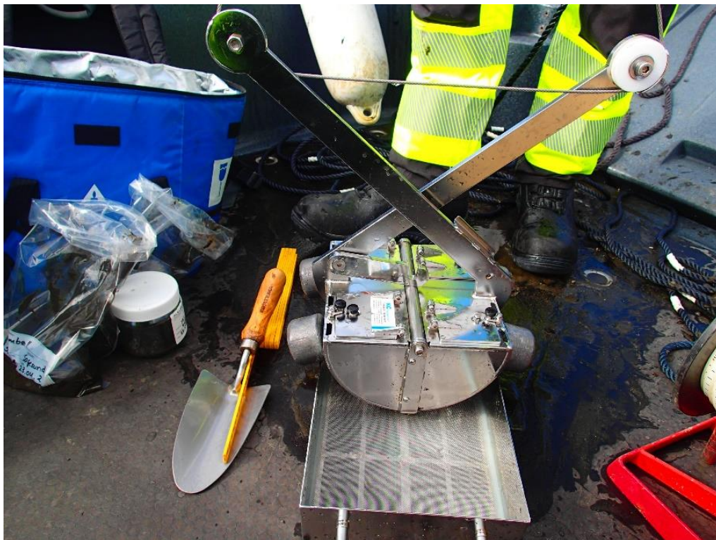
Figur 2: Van Veen grabb (250 cm 2 ) benyttet til prøvetaking ved E134 Tovstul bru i april 2022.
