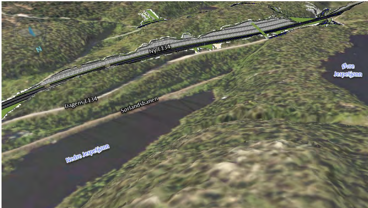
Figur 3-24: Alternativ 3 i skråningen ovenfor Nedre Jerpetjønn. Økt vegbredde og slakere kurvatur gir noe høyere skjæringer og fyllinger enn i øvrige alternativer
