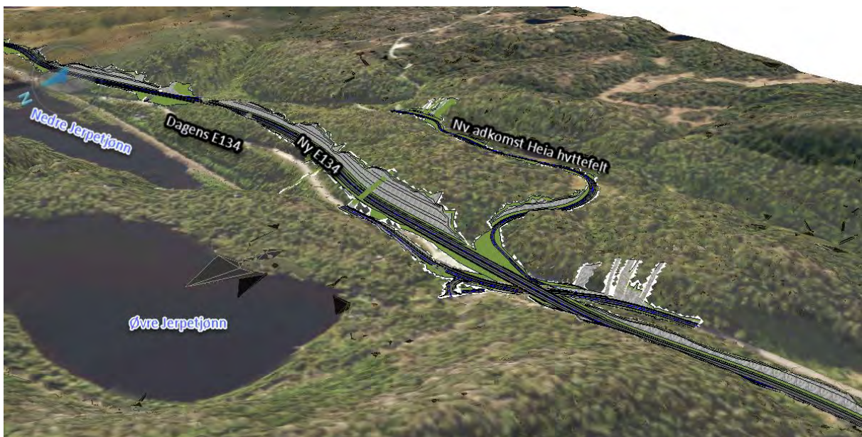
Figur 3-15: Mulig ny atkomstløsning for Heia hyttefelt, fra omlagt veg vest for Øvre Jerpetjønn, eller atkomst som i dag, med kulvert under ny E134
