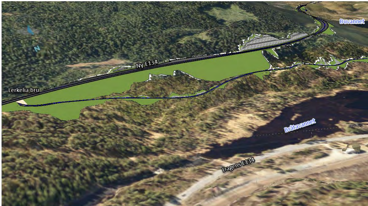
Figur 3-12: Ny E134 sett mot vest i Lerkelia/Buvannlia. Driftsveg for skogbruket, viltkryssing og tursti krysser ny E134 under Lerkeliabrua
