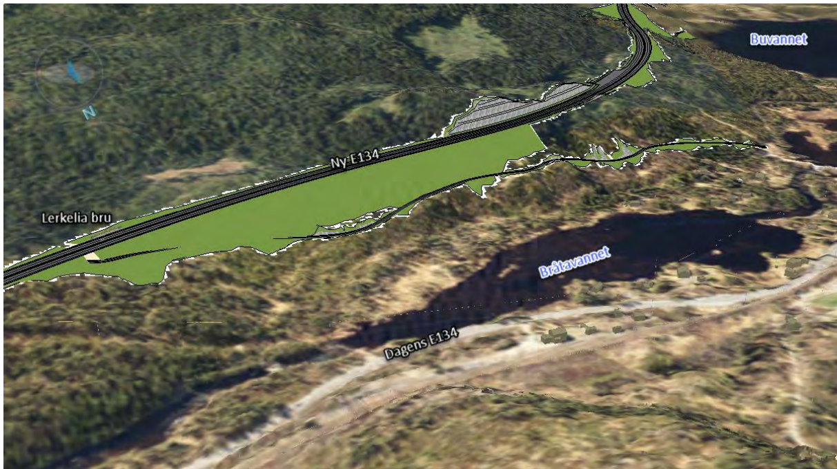
Figur 3-23: Alternativ 3 i skråningen mot Lerkelia. Økt vegbredde og slakere kurvatur gir noe høyere skjæringer og fyllinger enn i øvrige alternativer
