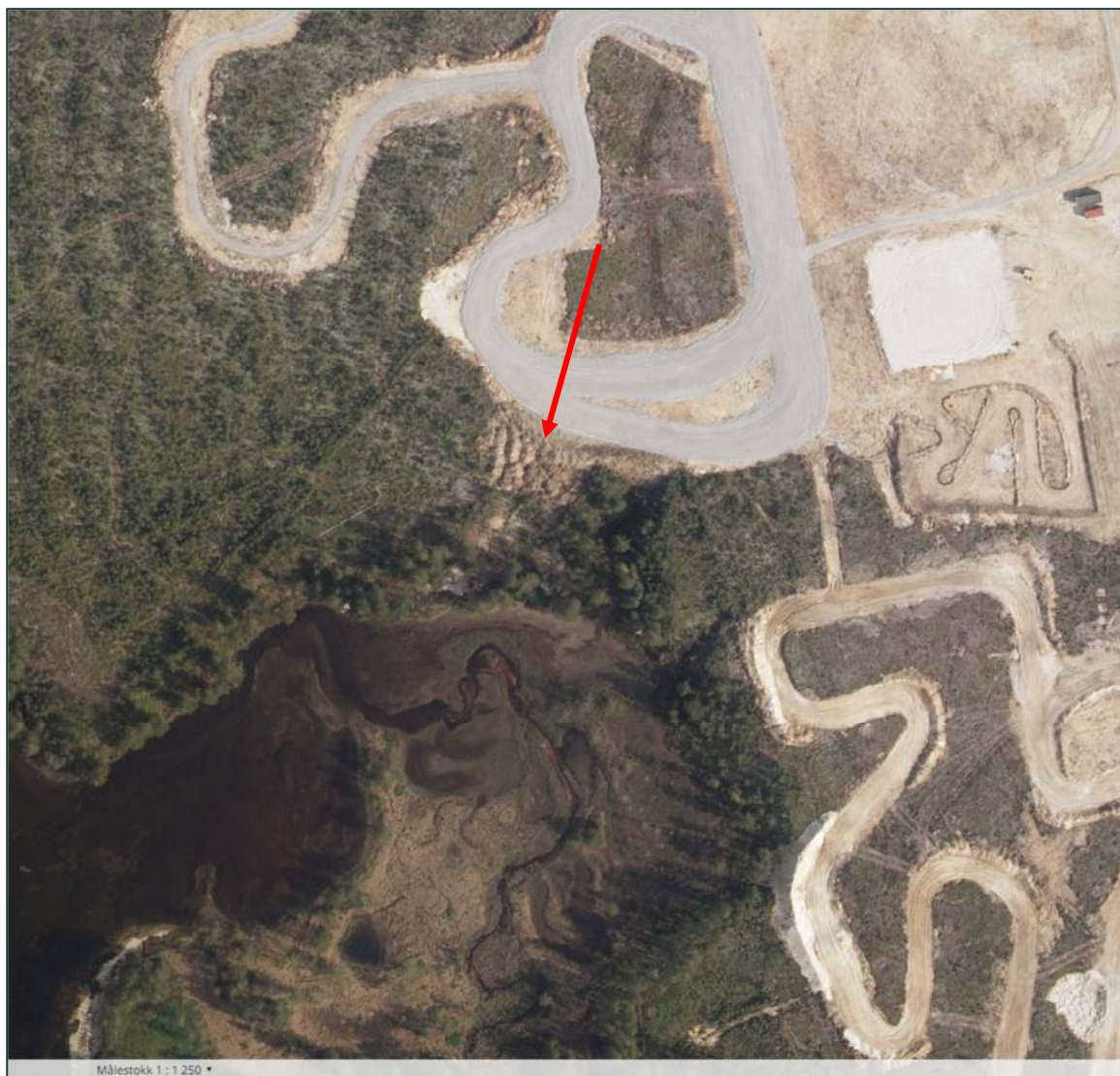
Figur 9-7: Ravinen hvor det er tatt ut grunnvannsprøver er vist med rød pil. Flyfotoet viser også overfyllingen av den nordlige delen av ravinen, pga. opparbeidelsen av motocrossbanen.
