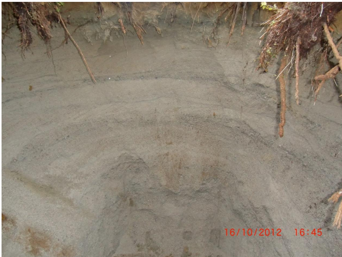
Bilde 2: Sjakt 2 viser lagdelt sand og grusig sand.
