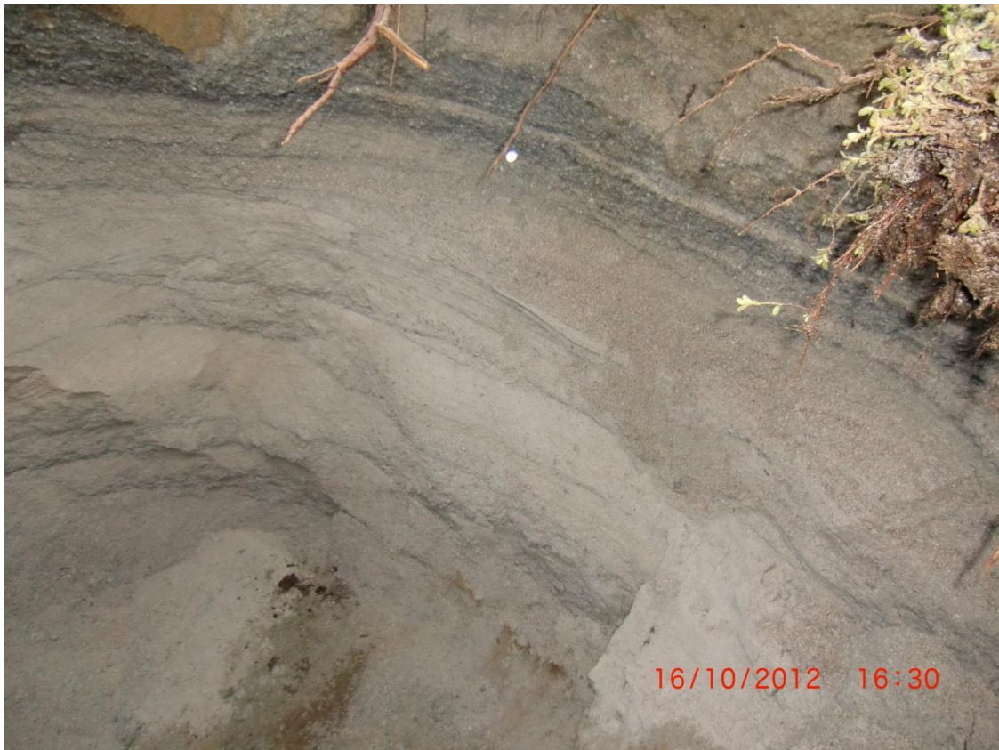
Bilde 1: Sjakt 1 viser lagdelt sand og grusig sand.
