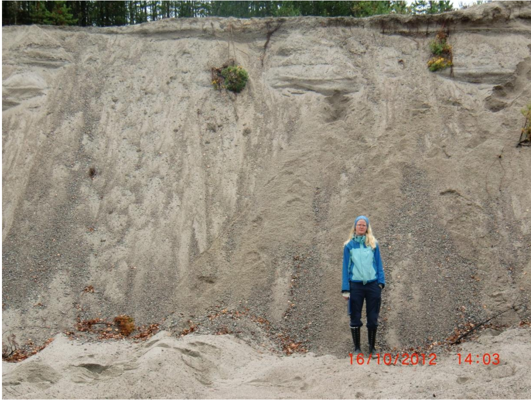
Bilde 6: Sandtak langs fylkesveien, øst for sjakt 6 og 7, viser lagdelt sand og grusig sand.
