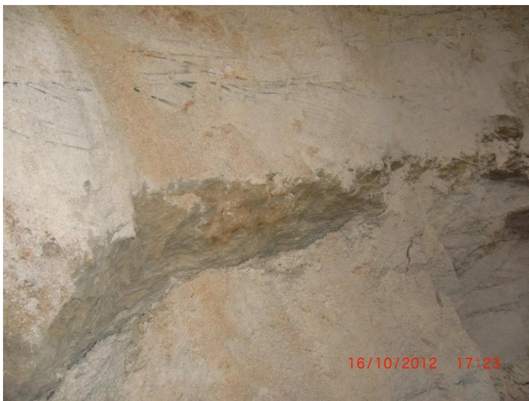
Bilde 3: Sjakt 4 viser 1,5 m lagdelt sand over 0,3 m siltlag. Under er det sand.
