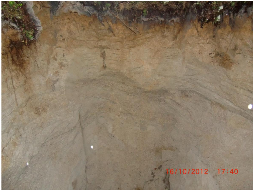
Bilde 4: Sjakt 5 viser lagdelt sand og grusholdig sand.
