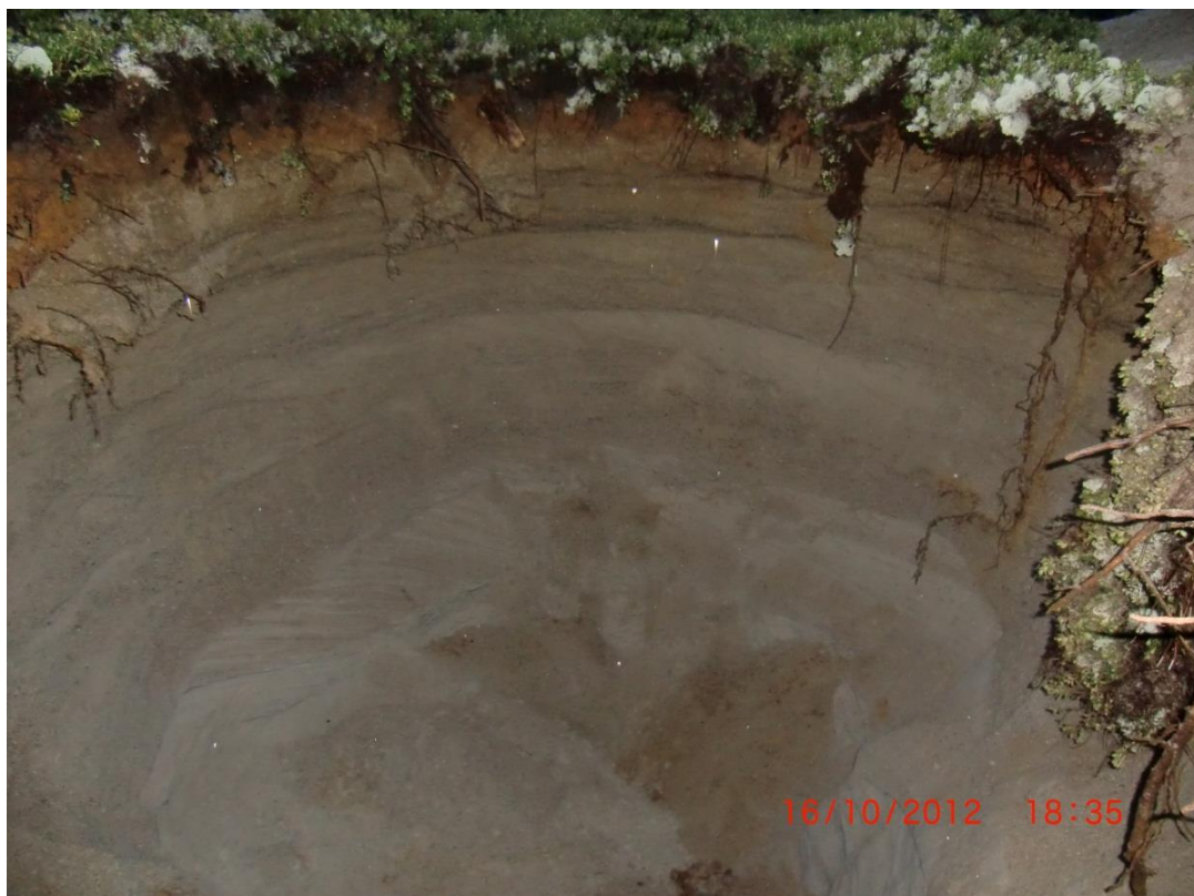
Bilde 5: Sjakt 7 viser grusig sand over sand.
