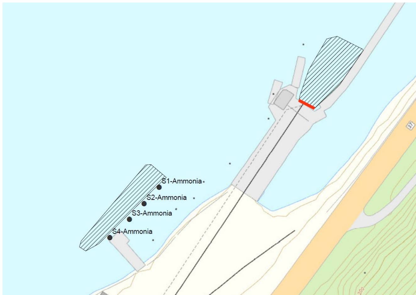
Figur 1. Utsnitt av prøvetakingsplan, med fotavtrykket til ønsket mudringsområde ved opplag Ammonia (lengst sør) og opplag Storegut (lengst nord) vist med svart skravur. Ferjelem Storegut er vist med rød strek, og ca. plassering av delprøvepunkt Ammonia, er tegnet inn med svarte sirkler.
