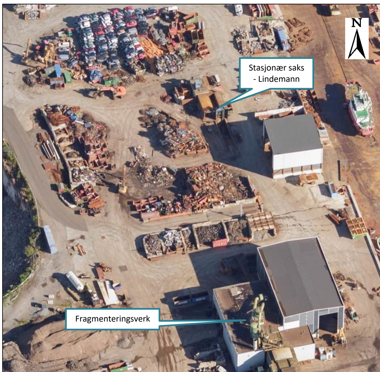
Figur 4-1: Bilde fra deler av Norscrap West sin virksomhet, hvor man kan se en del lagring av metallavfall. Bildet er hentet fra kartløsningen tilknyttet www.1881.no .
