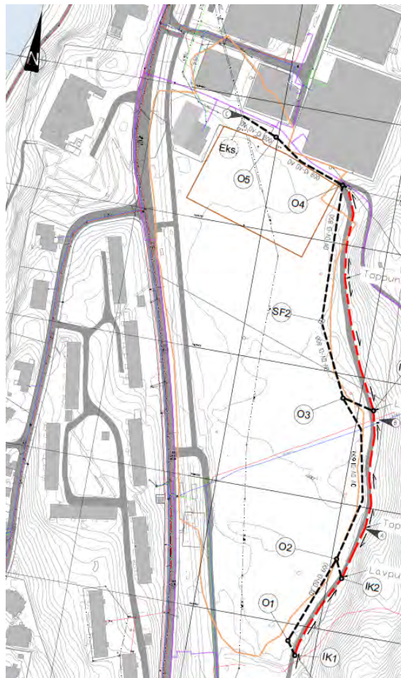
Figur 5: Oversikt over planlagt lokalisering av ny overvannsledning (sort stiplet linje) og avskjærende grøft (rød stiplet linje).
