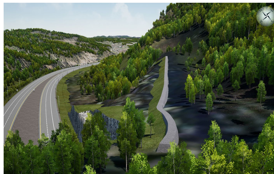
Figur 4-17. Skredvoll ved Høghåmmårtunnelen påhugg nord. Type 1 nærmest forskjæringen som går over i type 2 mot nord.
