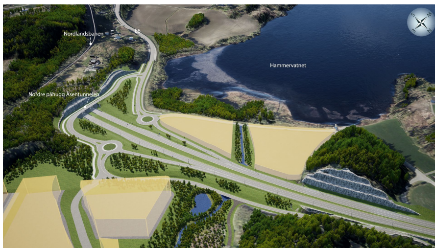
Figur 4-52. Prinsipp for parklik vegetasjon ved Hammerkrysset. Det plantes grupper av trær mellom vegene, og lave busker i rundkjøringene. Ellers benyttes naturlig revegetering overalt i prosjektet på vegskråninger og bekkedrag.
