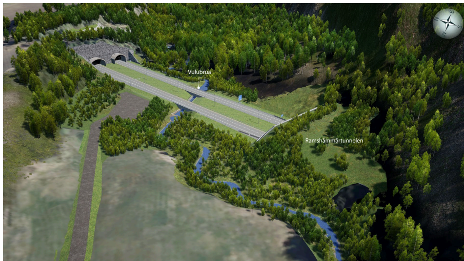
Figur 4-20. Dagsone Kleiva. Omlegging av Vulua med kryssing av E6 i kulvert, samt viltpassasje over portal Ramshåmmårtunnelen nord.
