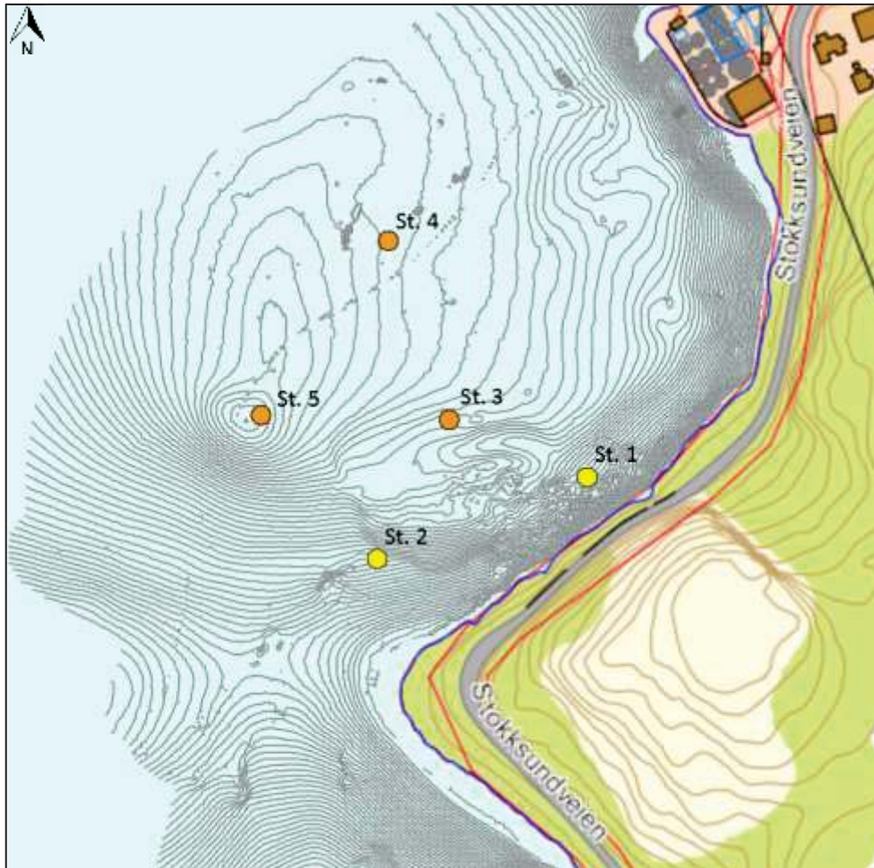
Figur 3-7 Tegning med prøvestasjoner markert med fargesymbol for høyeste påviste tilstandsklasse (gul = tilstandsklasse III – moderat tilstand, oransje = tilstandsklasse IV – dårlig tilstand).
