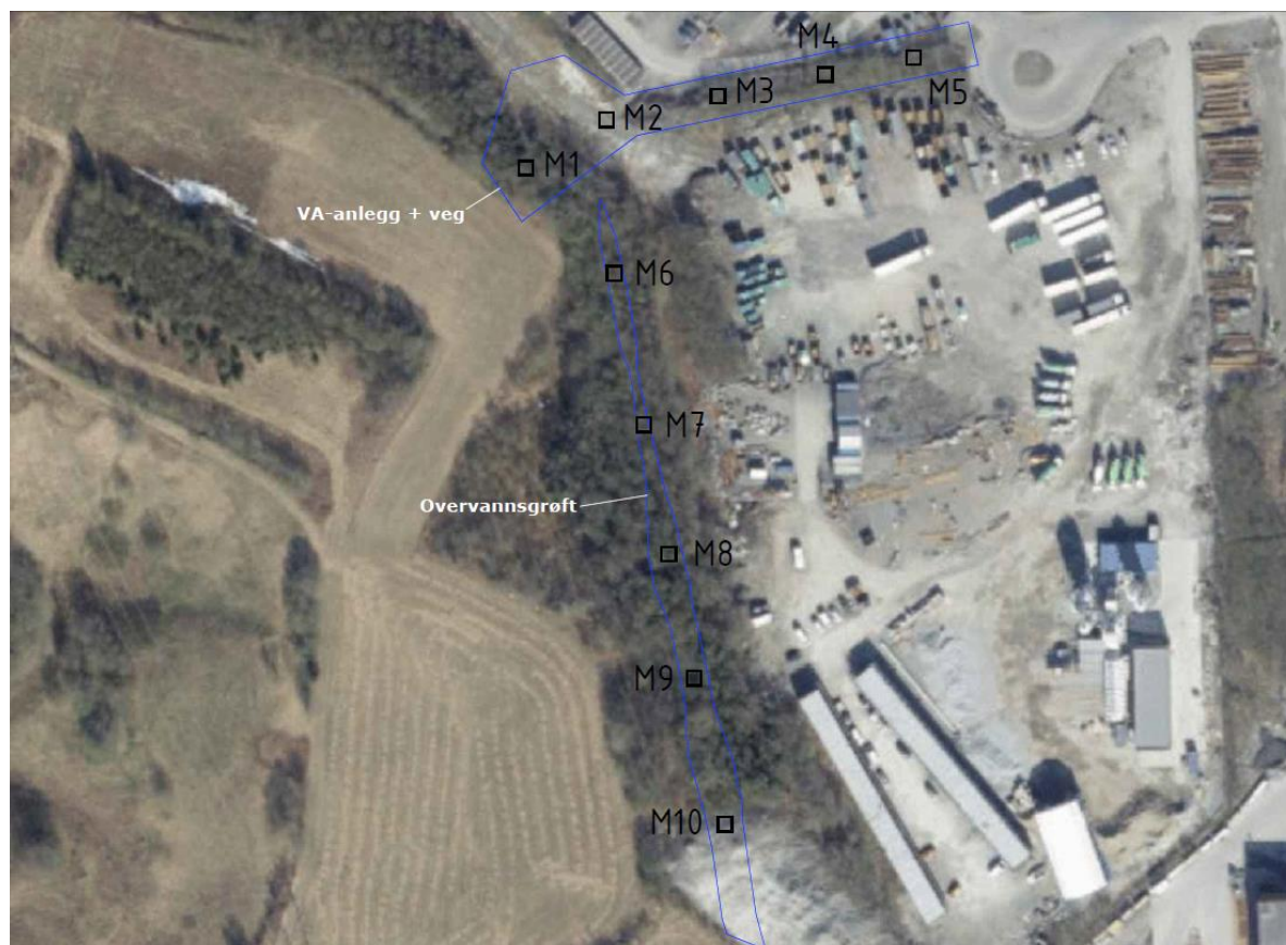
Figur 4. Prøvetakingsplan som viser plassering av sjaktene under den miljøtekniske grunnundersøkelsen
