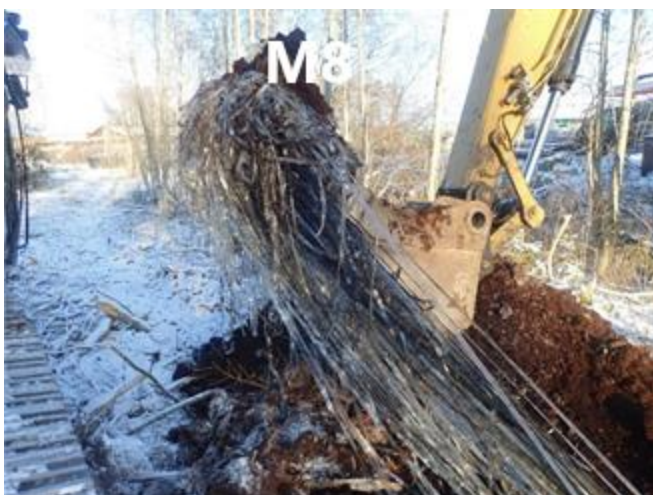
Figur 5. Sjakt M1, M2, M4, M6, M8 og M10 som representerer avfallsmassene som ble påtruffet under den miljøtekniske grunnundersøkelsen; plast, papir, trevirke, metallskrap, gummi, glass, tegl, mm. I sjakt M2 bestod øvre 0,8 m av grov steinfylling etterfulgt av vegduk og avfallsmasser.
