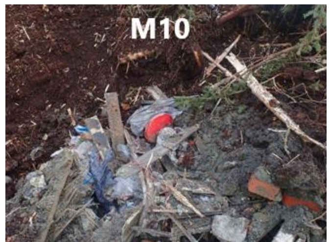
Figur 5. Sjakt M1, M2, M4, M6, M8 og M10 som representerer avfallsmassene som ble påtruffet under den miljøtekniske grunnundersøkelsen; plast, papir, trevirke, metallskrap, gummi, glass, tegl, mm. I sjakt M2 bestod øvre 0,8 m av grov steinfylling etterfulgt av vegduk og avfallsmasser.
