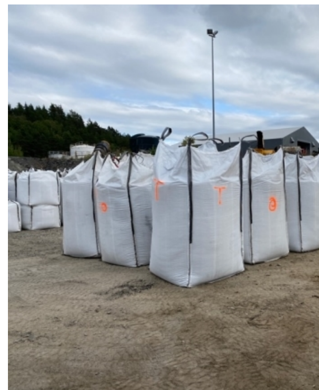
Sand og SBR/TPE/EPDM fjernes, renses, tørkes og plasseres i big-bags, klargjort for gjenbruk
