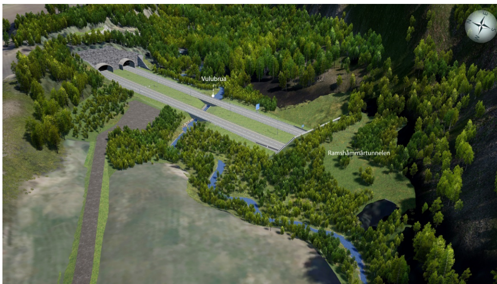
Figur 68: 3D-illustrasjon av planlagt kryssingsløsning av Vulua. Nytt bekkeløp kan ses som blått meanderende område. Flomslette etableres på sidene av bekkeløpet.
